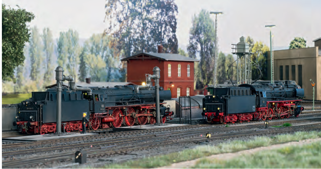
Zwei Loks stehen über dem Schlackensumpf. Entschlacken war eine schmutzige und oft auch zeitraubende Arbeit, die schon mal eine halbe Stunde in Anspruch nehmen konnte.
