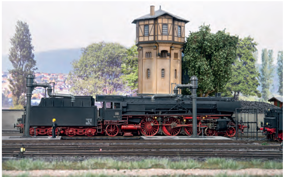
001 150 steht am Wasserturm. Die Loks sind durstig, in die Schlepptender passten bis zu 34 Kubikmeter Wasser – das reichte je nach Lokbeanspruchung für bis zu 200 Kilometer.
