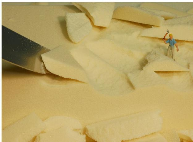
Bei der Feinbearbeitung ist die harte und poröse Struktur des leichten Werkstoffes (im Vergleich zum elastischen und zähen Styrodur und Styropor, was sich sehr schlecht schneiden und sägen lässt) von großem Vorteil.
